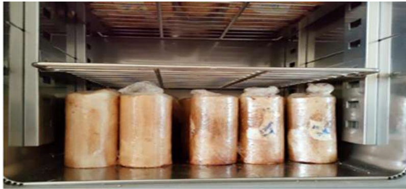
Figure. 1. Cure des échantillons
