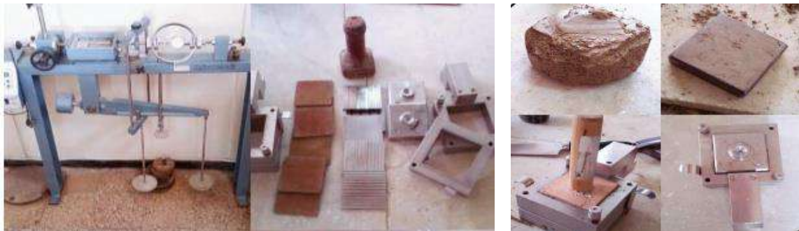
Figure 4. Appareillage de cisaillement et préparation de spécimens
