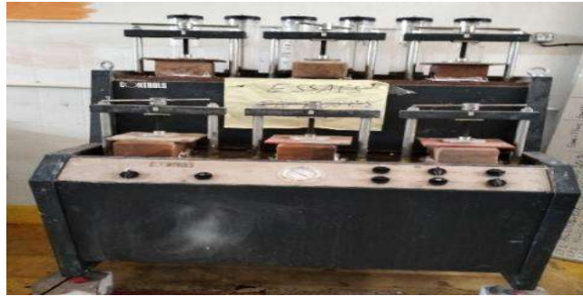
Figure 1. Appareil de mesure de la perméabilité à l'eau
