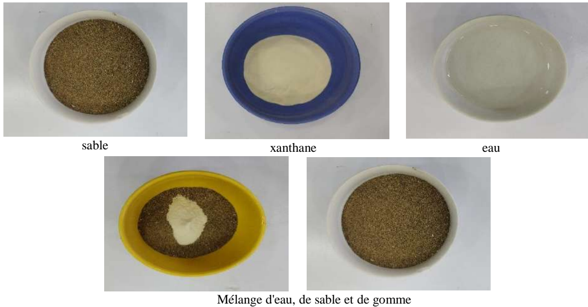
Figure. 3. Etapes de préparation des mélanges sable-gomme de xanthane.
