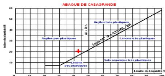
Figure.3. Courbe limites d'Atterberg et classification du sol étudié.
