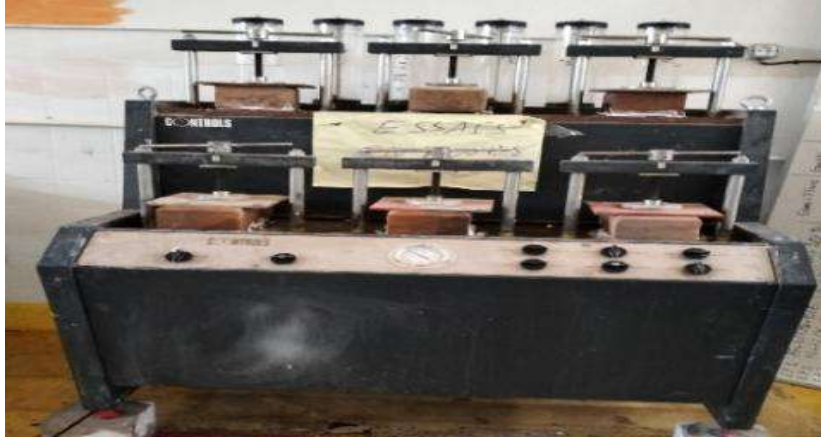
Figure. 1. Appareil de mesure de la perméabilité à l'eau
