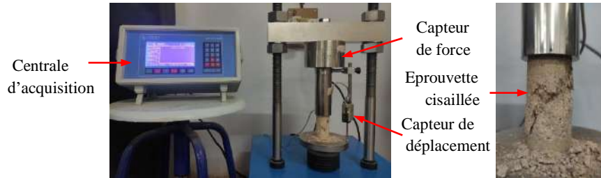
Figure. 1. Les étapes de la détermination de la résistance à la compression simple.
